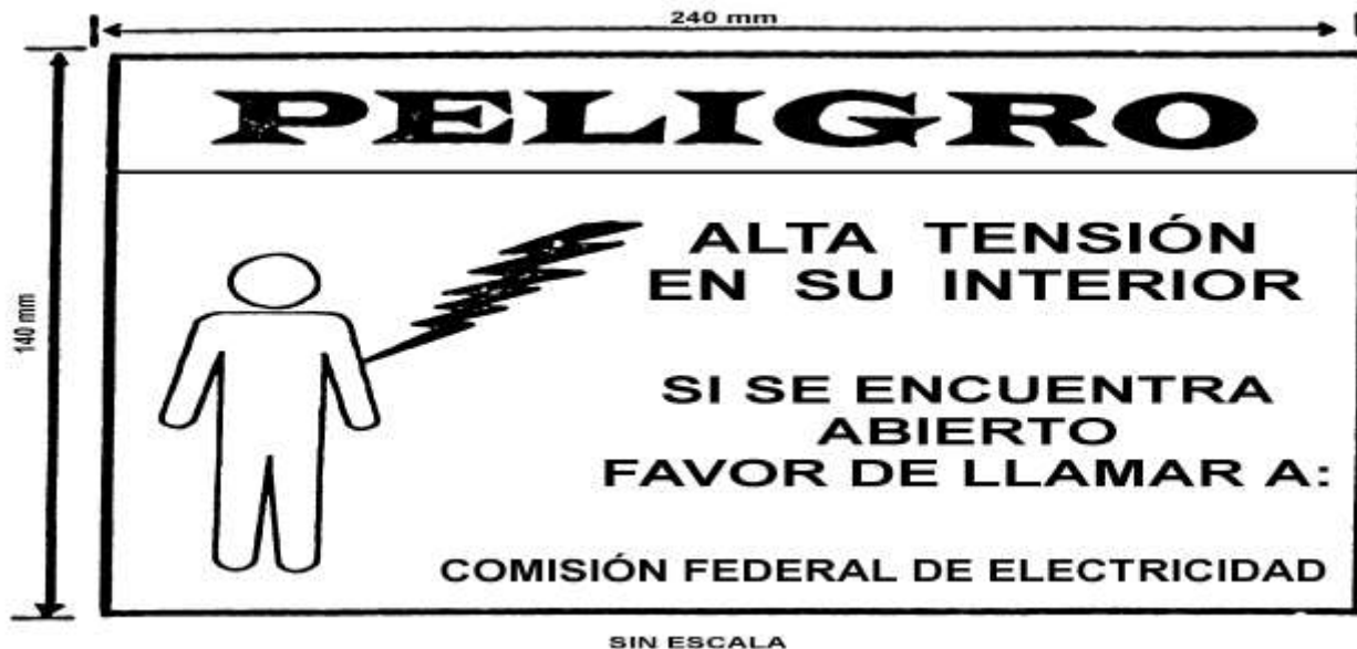
FIGURA 5.- Señal preventiva y de riesgo
