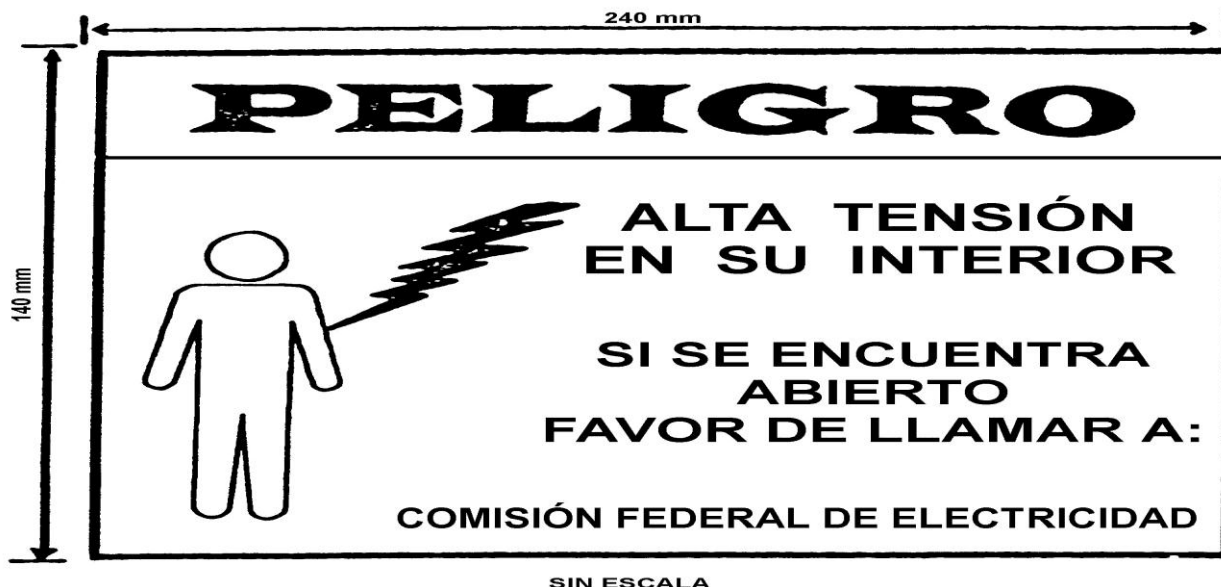
FIGURA 7 - Señal preventiva y de riesgo
